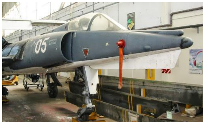
Le 05, comme le 04, est équipé de cette fameuse quille de nez qui augmente la stabilité en roulis et abrite l'antenne de télémétrie des missiles
